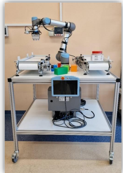
17 pav. Robotizuotas logistikos sprendimų simuliacijos stendas su kolaboratyviu robotu
